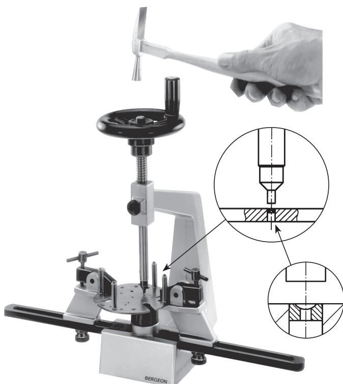
1. Enlever la platine. Démonter la platine. Celle défectueuse est remise en place sur la potence. Fixer à la broche un tasseau à chasser correspondant à un diamètre légèrement plus grand que celui du bouchon à chasser. Appuyer avec une main sur le volant pour supprimer l'effet du ressort. Procéder au chassage en frappant avec un marteau de préférence en laiton.
