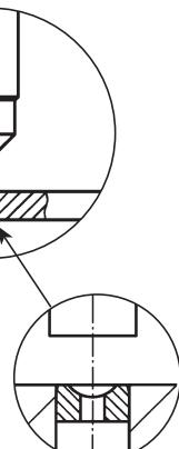
**1.** Placer dans le trou de base de la potence une enclume à trou pour soutenir la platine. Poser la platine entre les deux chiens. Fixer la pointe à centrer No 6 à la broche. Déterminer l'emplacement exact du trou primitif et serrer définitivement les chiens.
